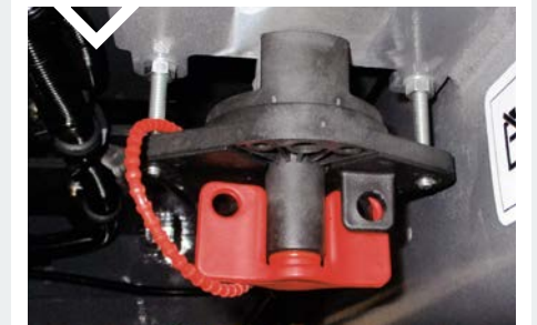
LOG OUT TAG OUT BATTERIETRENNNSCHALTER
